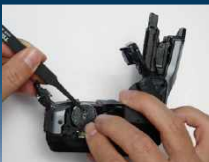
Cuchilla sustituible por el usuario
